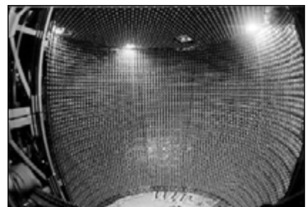
Stěna a strop „nádob“ detektoru Super-Kamiokande s více jak 9000 nainstalovanými fotonásobiči při stavbě v roce 1995
