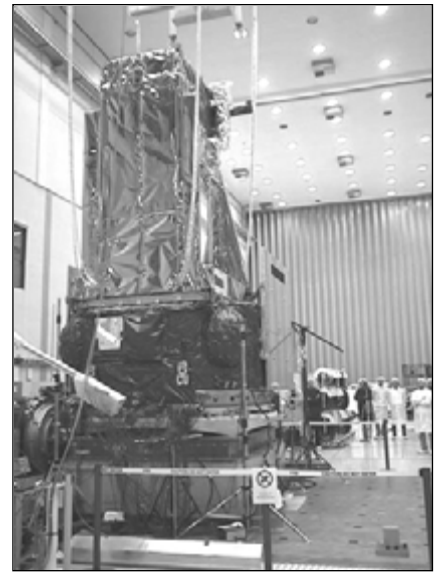
Družice INTEGRAL při vibračních testech
