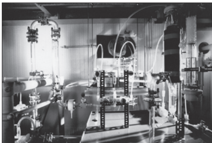
Radiochemické detektory využívající galium umožnily detekovat neutrina z p-p cyklu. Experiment GNO byl pokračovatelem experimentu GALLEX .
