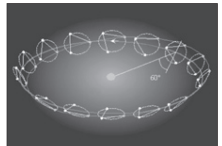
Obr. 6. Schéma oběžných drah tří družic, které budou tvořit interferometrický detektor gravitačních vln LISA v kosmickém prostoru
