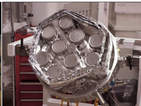
Umělecká představa družice RHESSI (vlevo) a fotografie jejích germaniových detektorů (vpravo)
