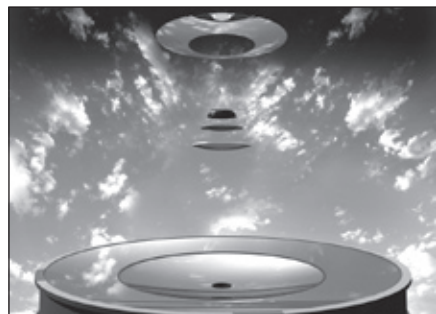
Optické schéma dalekohledu LSST je tvořeno třemi zrcadly a třemi refraktivními prvky.
