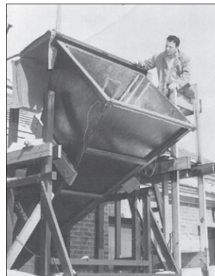
Harold Ewen kontroluje trychtýřovitou anténu, se kterou byla v roce 1951 objevena emise neutrálního vodíku na vlnové délce 21 cm
